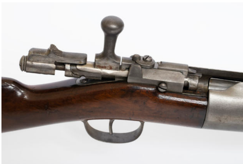
Pohled na otevřený závěr s částí cívkového zásobníku systému Špitálský. Foto P. Krásenský.
